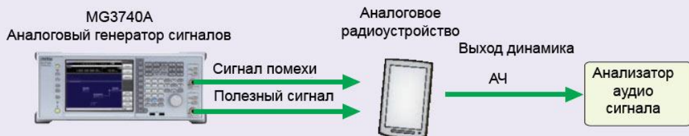
Схема подключения для измерения характеристик аналогового радиоприемника
